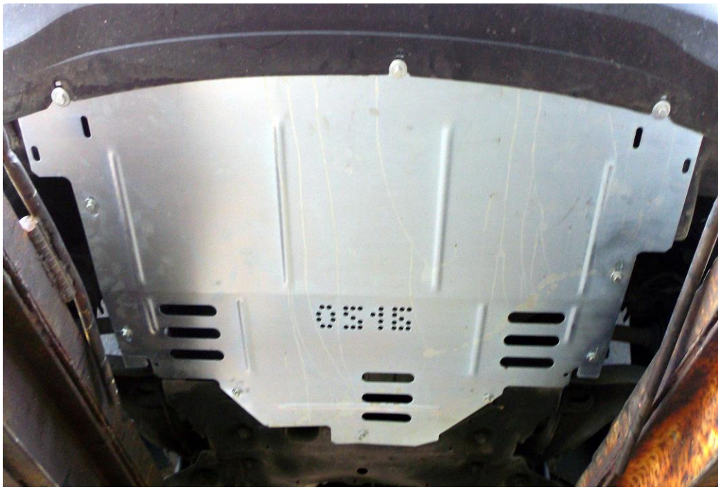
Kryt chrání motor, převodovku, chladič.
